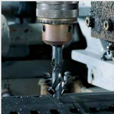
Lochen von PEHD-Rohren
